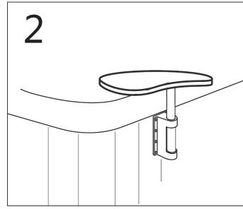
1. Skruvar fast täckbrickan, i sidoplanelen för sedan ner avlasningbrickan på plats.
